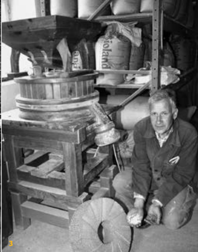
3 Für die Osttiroler Getreidemühle der Biohof-Bäckerei Ilg von Wolfgang Strakosch hergestellte Basalt-Mühlsteine mit 0,4 m Durchmesser (Foto: Bärbel Schoen)
