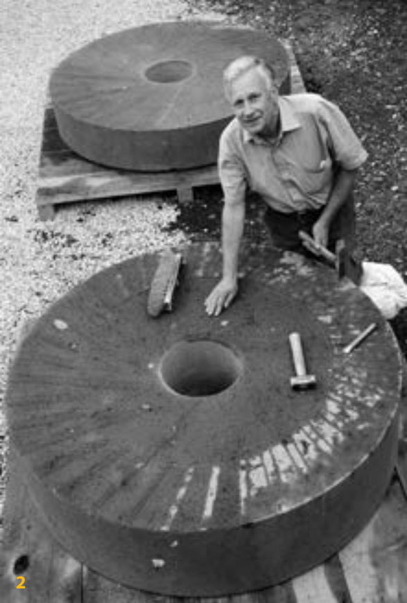
2 Wolfgang Strakosch fertigt einen Boden- und einen Läuferstein mit 1,40 Meter Durchmesser für die 1813 erbaute Windmühle Bardowick in der Nähe von Lüneburg. (Foto: Bernd-Ulrich Wagner)
