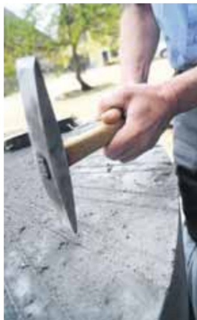
Die Bille ist das wichtigste Werkzeug zur Bearbeitung von Mühlsteinen.
